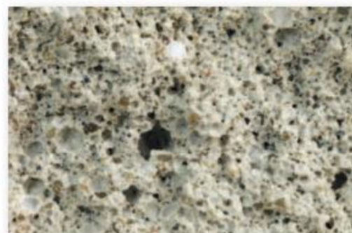
Krohvi SP G sisemine poorne struktuur.
